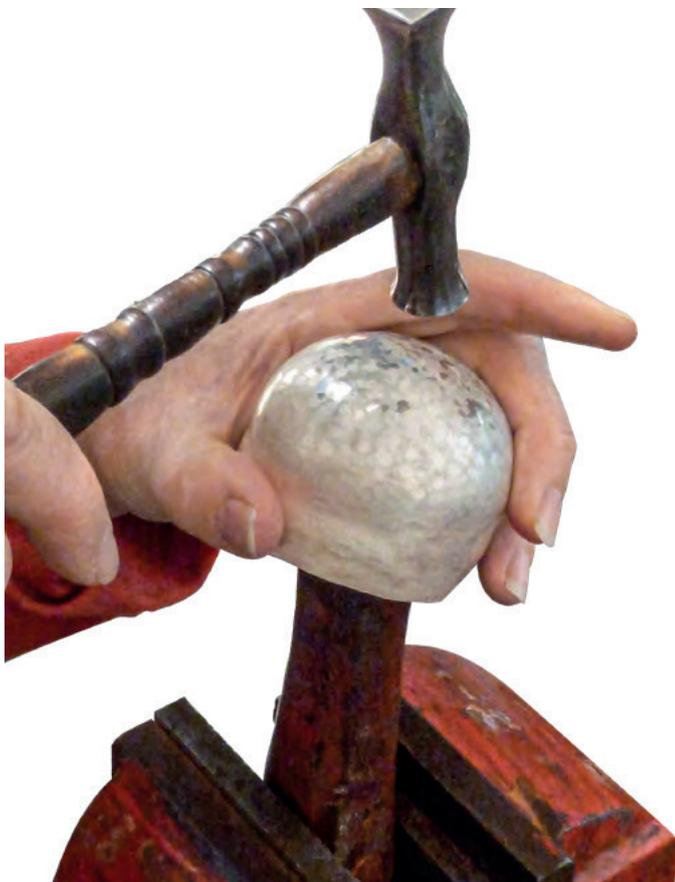
Durch Planieren wird das Werkstück geglättet.
