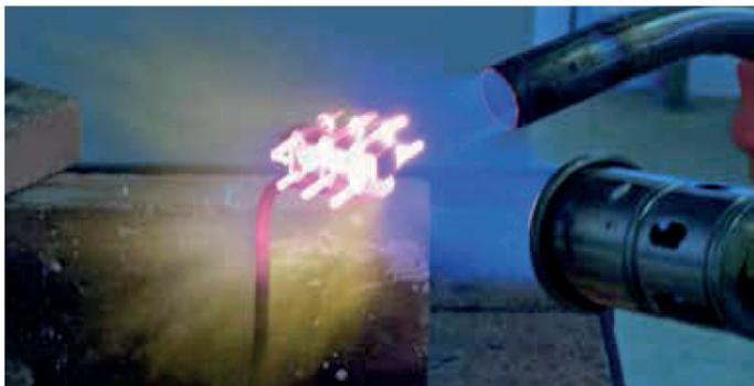
Schichtblock wird geschmolzen.
